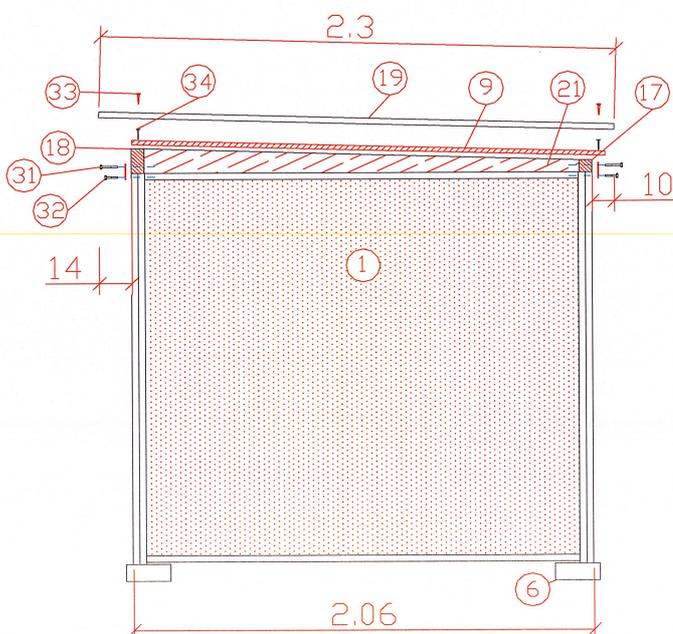
11. Dachblende Nr. 10 (braunes U-Profil) aufschieben – zuvor die Schutzfolie abziehen.
