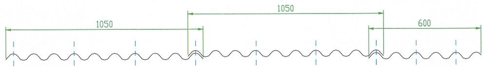
Bohr-Schema für Dachholz hinten
